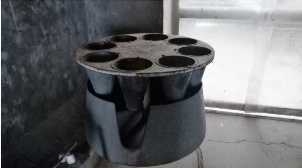
*Dans l'atelier, la machine à sacrifier les volailles.*
